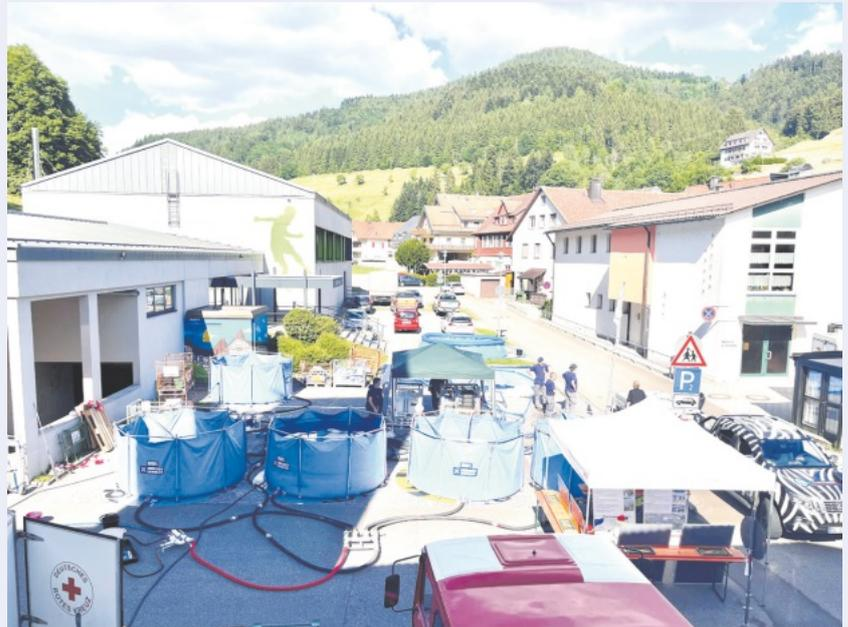
Die Fachgruppe Trinkwassernotversorgung des DRK-Landesverbandes Badisches Rotes Kreuz wird im Krisenfall als mobile Einheit tätig. Mit ihrer Trinkwasseraufbereitungsanlage können 6.000 Liter Trinkwasser aus Oberflächenwasser aufbereitet werden. Damit können 5.000 Menschen mit 15 Litern Trinkwasser pro Tag versorgt werden.
